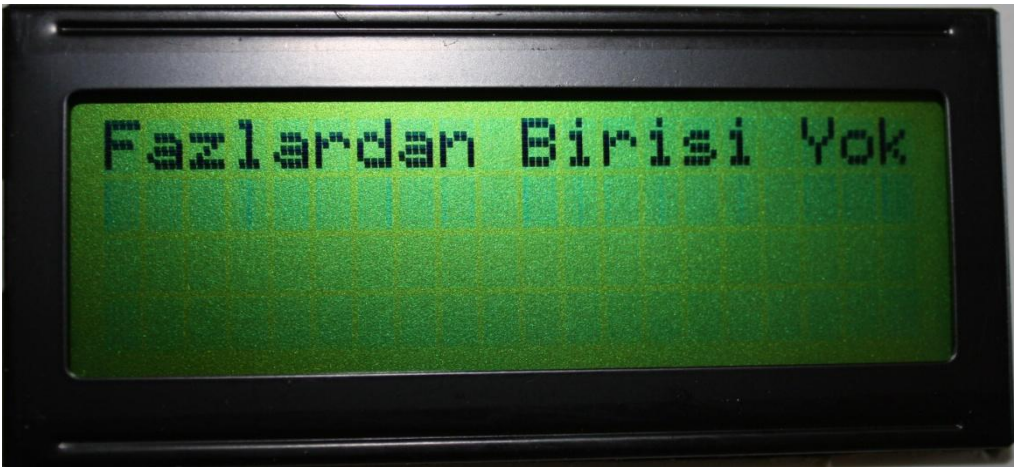
Şekil 5.3 Fazlardan birinin arızalı olduğu durum
