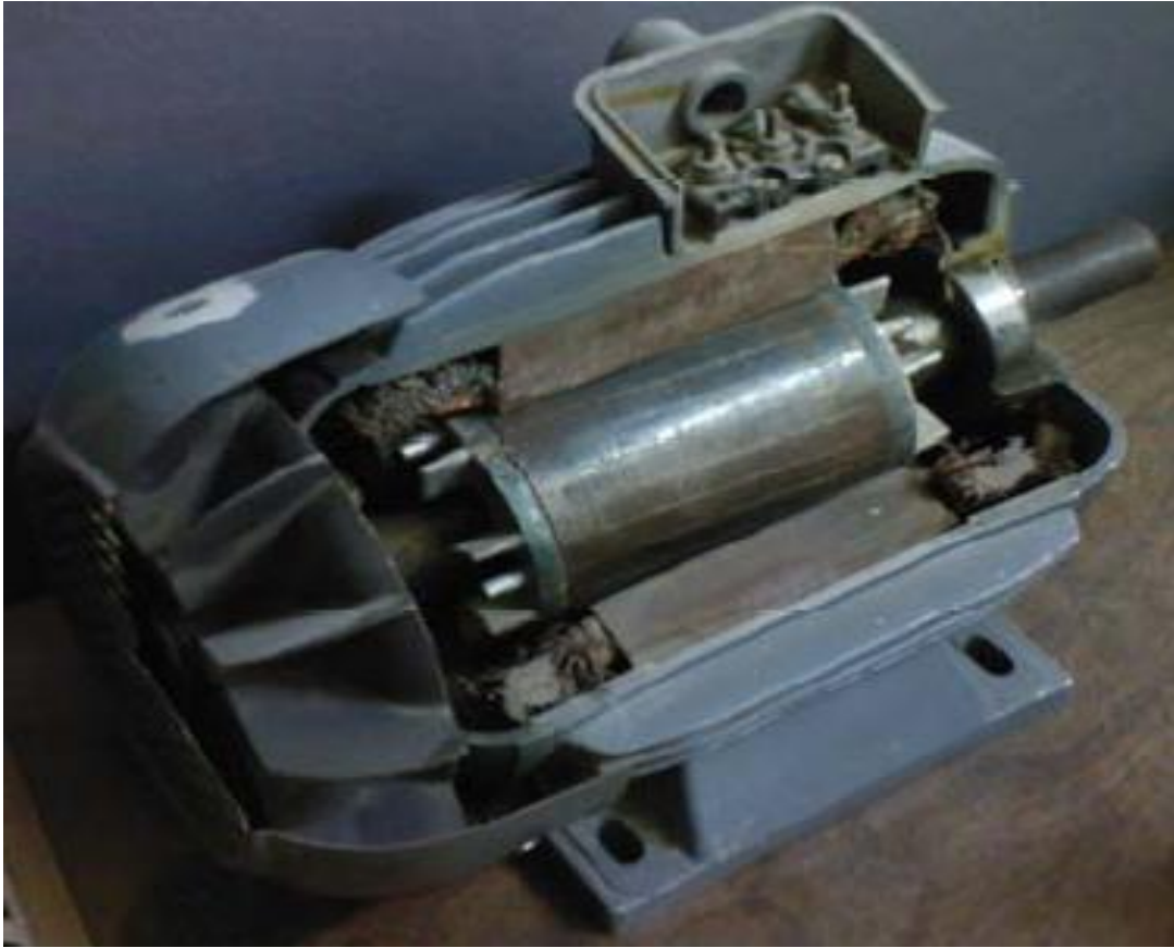
Şekil 1.1 Asenkron Motorun İç Yapısı
