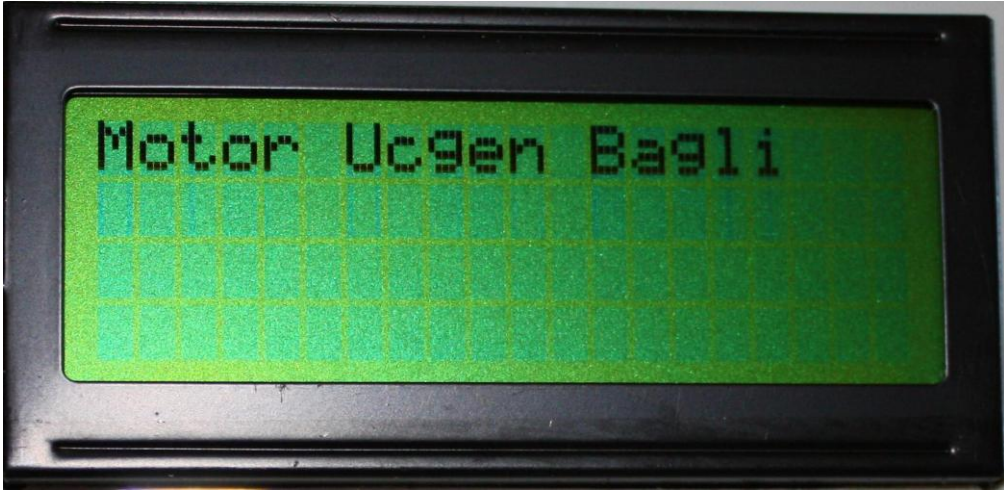
Şekil 5.2 Faz sırasının mikrodnetleyici tarafından doğrulanıp asenkron motor sargılarının üçgen bağlandığı durum
