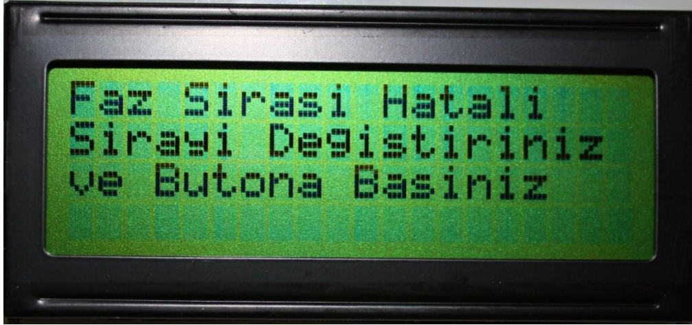
Şekil 5.4 Faz sırasının hatalı olduğu durum
