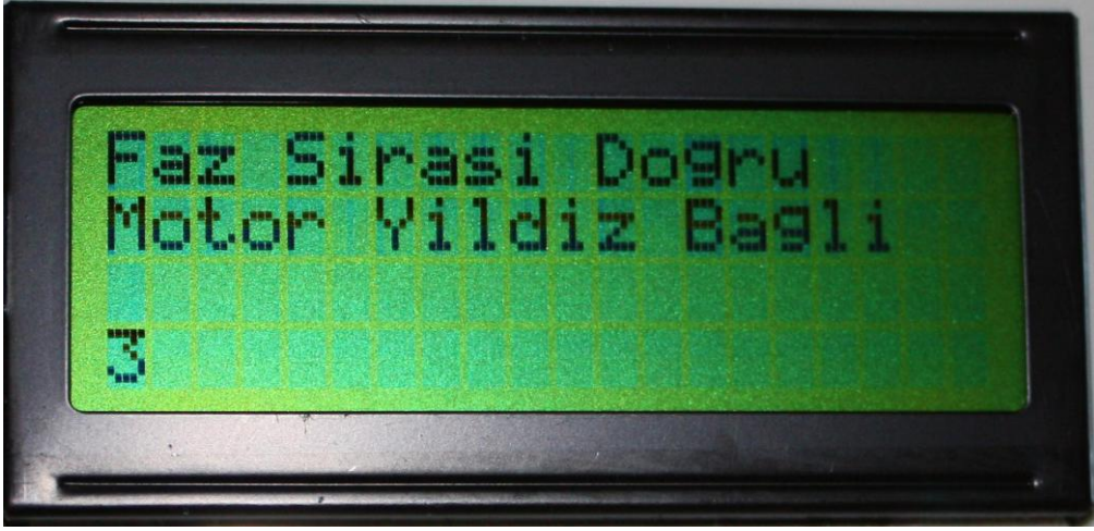
Şekil 5.1 Faz sırasının mikrodnetleyici tarafından doğrulanıp asenkron motor sargılarının yıldız bağlandığı durum
