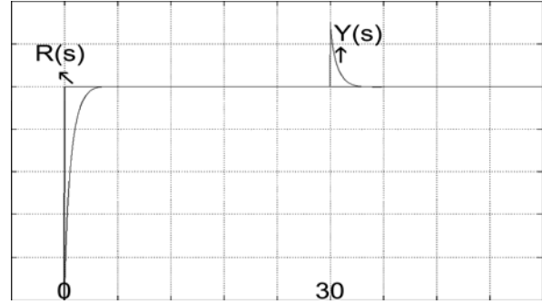
Şekil-7. Sisteme Bozucu Etki Etmesi Durumunda Sistemin Birim Basamak Cevabı.
