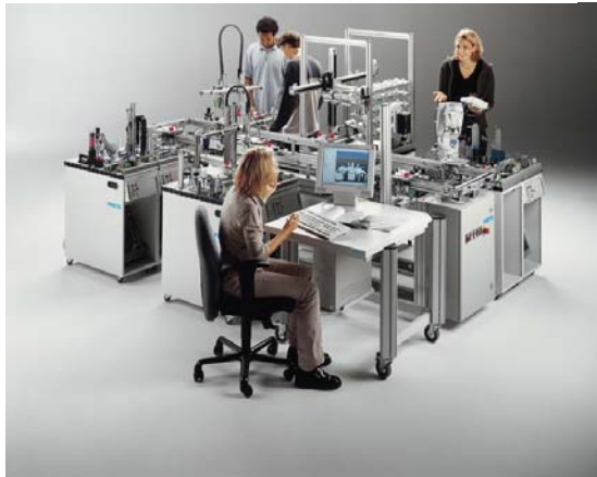
Şekil 8: Mekatronik eğitim programı için hazırlanmış örnek esnek üretim sistemi
