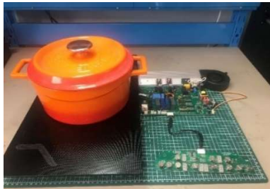
Şekil 30. YKSR İnvter için uygulama devresi [42].
