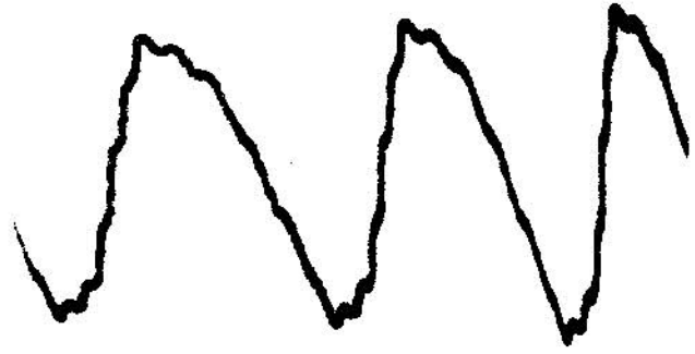
Şekil 6. Hat işçisinin vücudundan geçen 200 \mu A'lık endüklenme akımının dalga biçimi.
