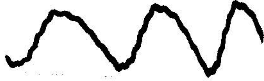
Şekil 5. Hat işçisinin vücudundan geçen 100 UA'lık endüklenme akımının dalga biçimi.
