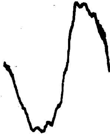
Şekil 7. Korona belirtilerinin görüldüğü 400 \mu A'lık endüklenme akımının dalga biçimi.
