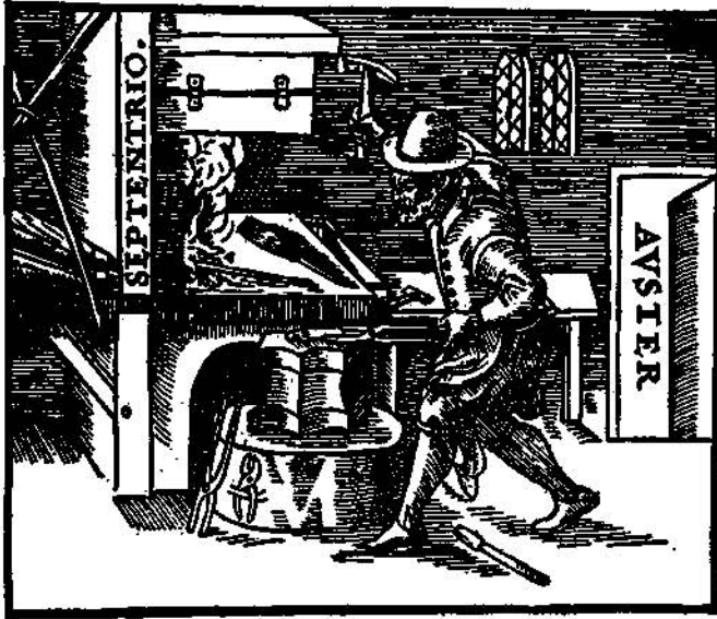
Şekil 1. Kızıncaya dek ısıtılan bir demir çubuk uç noktalan kuzeyi ve güneyi gösterecek şekilde soğuyuncaya kadar dövülürse mıknatıslanma süreci hızlanmaktadır. Gilbert'in De Magnete adlı kitabından.
