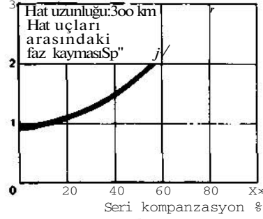
Şekil 16. Seri kompanzasyonlu hatlarda yüklenme düzeyi DEY: Dalga empedans yükü
