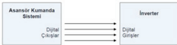
Şekil 6. Asansör Kumanda Sistemi ile İnverter Paralel Bağlantısı
