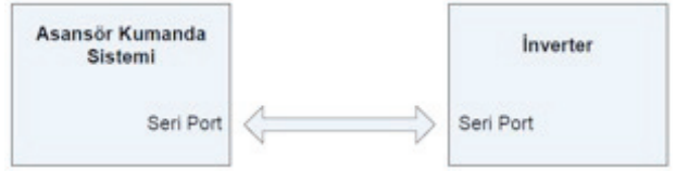
Şekil 7. Asansör kumanda sistemi ile inverter seri bağlantısı
