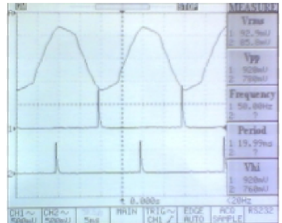
Şekil-10. TSR'li Sistem İçin Üretilen Tetikleme İşaretleri
