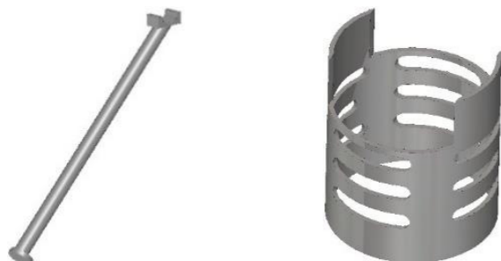
Şekil 5: Soldan sağa ayak ve faydalı yük muhafaza yapısı
