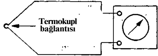
Şekil. 4 Doğrudan doğruya bir E.M.K. ölçme cihazının uçlarına bağlanmış bir termokupl.
