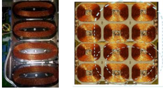
Şekil 14. Tek tencere ısıtma için çoklu bobin uygulama örnekleri.
