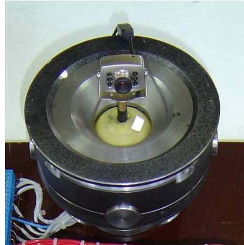
Şekil-1. Sabit mıknatıslı küresel motorlu kameranın genel görünümü.
