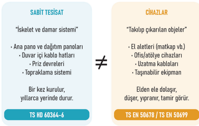
Şekil 1. Sabit tesisat ile cihazların niteliksel ayrımı ve bunlara tabi standartlar.
